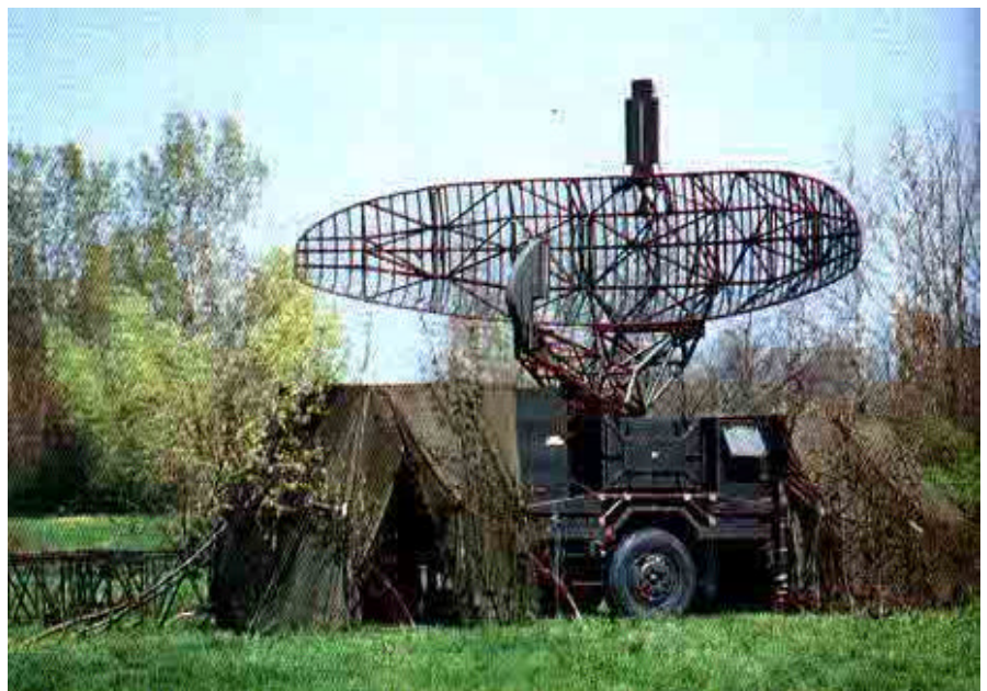
Sistema radar mobile montato su carro mimetizzato tra la vegetazione
